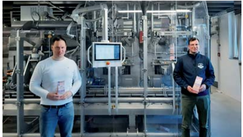
Mithilfe der Verpackungsmaschine Rovema SBS Twin lässt sich problemlos zwischen verschiedenen Beutelkopfformen, Packstoffen und Formatgrößen umstellen.
