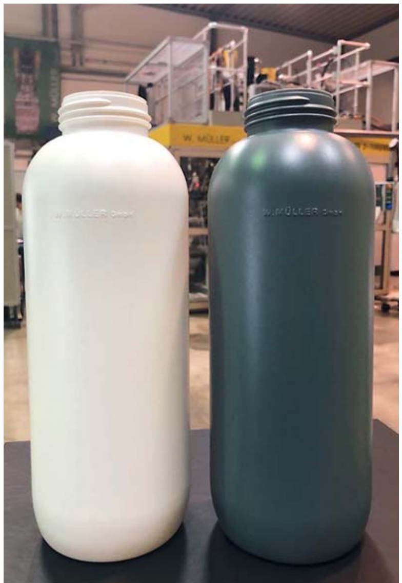
Für die Versuchsreihe wurden Flaschen aus reinem PCR hergestellt (r.), sowie mit dem Reco-3-Verfahren, die innen und außen eine Schicht aus Neuware besitzen.
